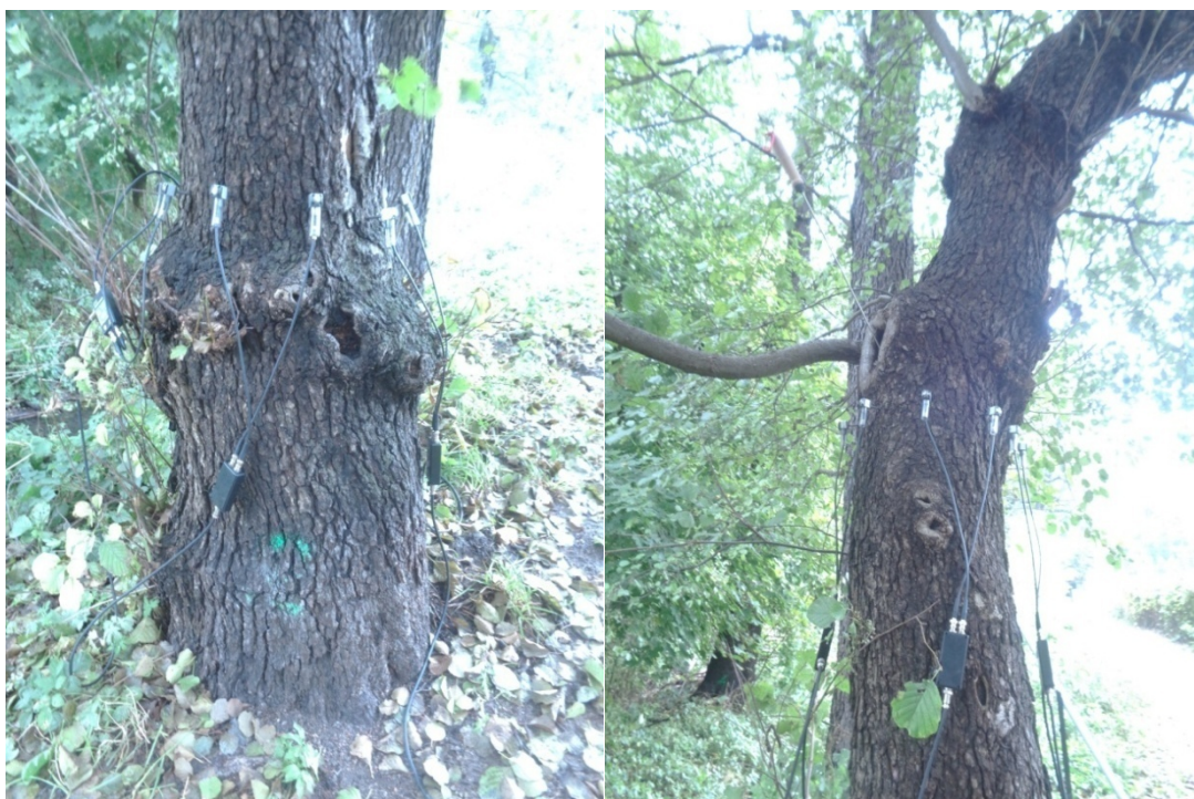
Fot. Badane tomografem na 2 wysokościach
