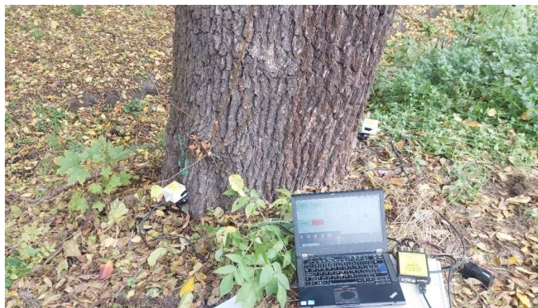
Fot. Wykonywanie testu obciążeniowego – rozmieszczenie inklinometrów
