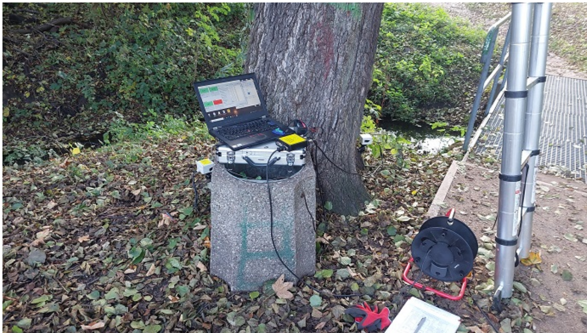
Fot. Wykonywanie testu obciążeniowego – rozmieszczenie inklinometrów
