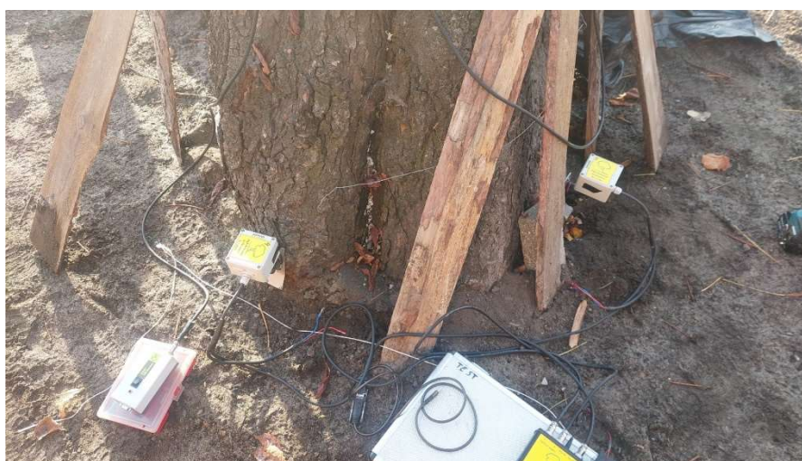
Fot. Wykonywanie testu obciążeniowego – rozmieszczenie inklinometrów
