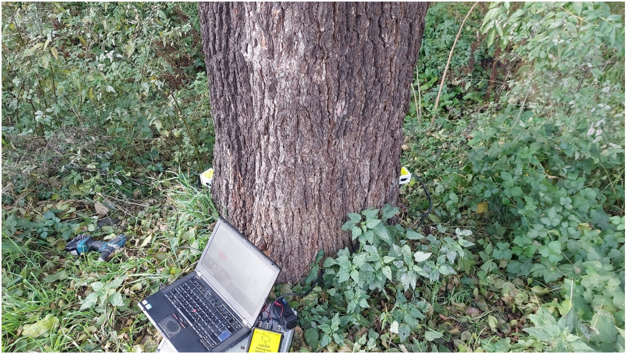
Fot. Wykonywanie testu obciążeniowego – rozmieszczenie inklinometrów
