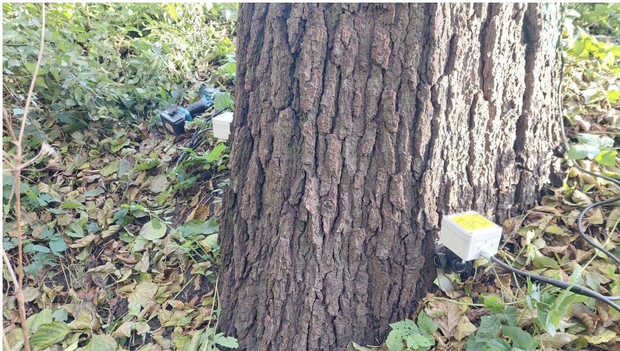
Fot. Wykonywanie testu obciążeniowego – rozmieszczenie inklinometrów
