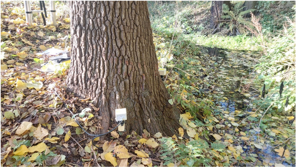
Fot. Wykonywanie testu obciążeniowego – rozmieszczenie inklinometrów
