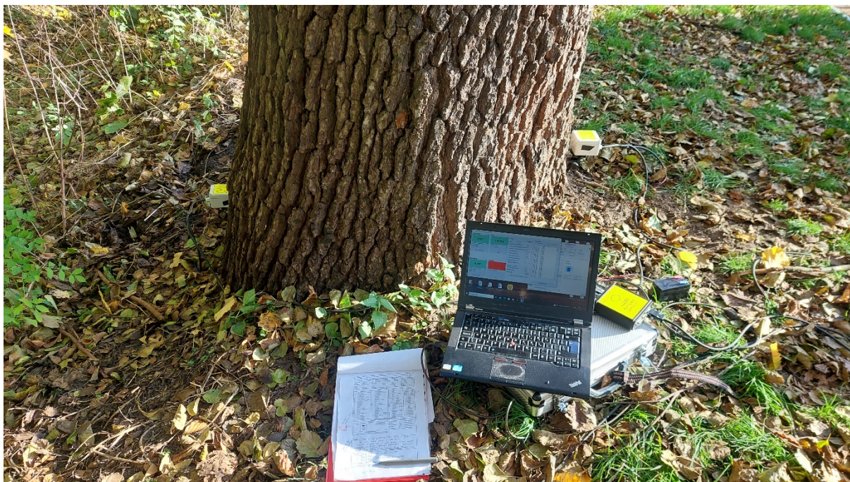
Fot. Wykonywanie testu obciążeniowego – rozmieszczenie inklinometrów
