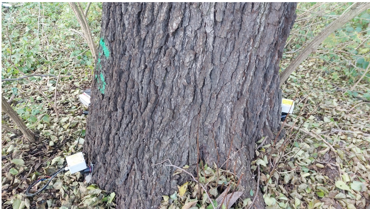
Fot. Wykonywanie testu obciążeniowego – rozmieszczenie inklinometrów
