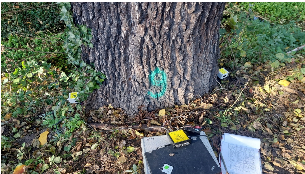
Fot. Wykonywanie testu obciążeniowego – rozmieszczenie inklinometrów
