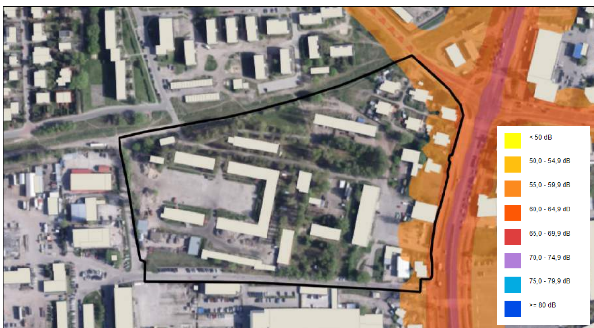
Rysunek 10. Przedziały hałasu drogowego w porze L_N (zasięg obszaru projektu planu zaznaczono czarną linią; źródło: mapahałasu.torun.pl)
