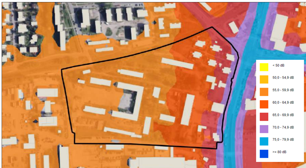
Rysunek 9. Przedziały hałasu drogowego w porze L_{DWN} (zasięg obszaru projektu planu zaznaczono czarną linią; źródło: mapahałasu.torun.pl)
